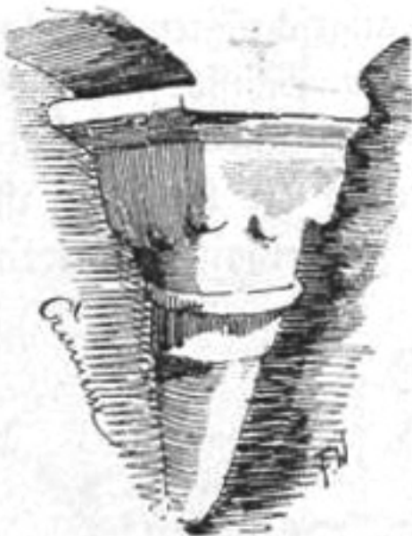
Abb. 59. Stütze in der Blende.
